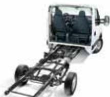
**35S: leichtes einzelbereiftes Fahrgestell mit Fahrerhaus**
